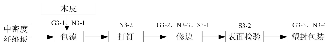
图 2-4 包覆贴面板生产工艺流程及排污节点图
