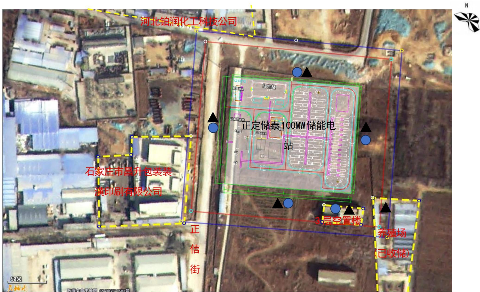
附图 10 本项目噪声、工频电场强度及工频磁感应强度监测点位布置示意图
